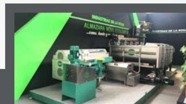
totalmente automatizado con la posibilidad de controlar todas las variables de la almazara desde un cuadro eléctrico con monitorización de datos desde una pantalla táctil, un solo operador podrá realizar y controlar todo el proceso de elaboración para la producción de un aceite de oliva de máxima calidad.
